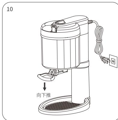
8. 把电源线插入插座中,然后旋转开关旋钮,启动冰淇淋机。
