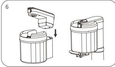
7. 将出料座安装到外杯底部, 逆时针旋转扣紧。
